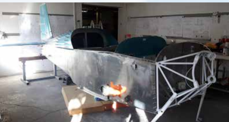
28.09.2019: Anbau und Ausrichtung des Leitwerks auf dem Rumpf und provisorischer Anbau des Motorträgers.
