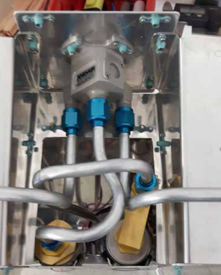
19.09.2019: Einbau der Benzinleitungen, des Benzinfilters und der Hochdruckbenzinpumpe
