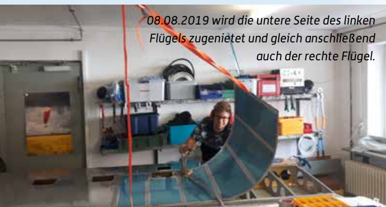
11.06.2019: Der Einbau der Spornradschwinge ist erledigt und am 04.07.2019 wird die extrem helle Beleuchtung von AERO-LED eingebaut. Nachdem das beheizte Pitot-Rohr, die Beleuchtung und der Autopilot-Servo eingebaut sind, können die Flügel zugentstet werden.
