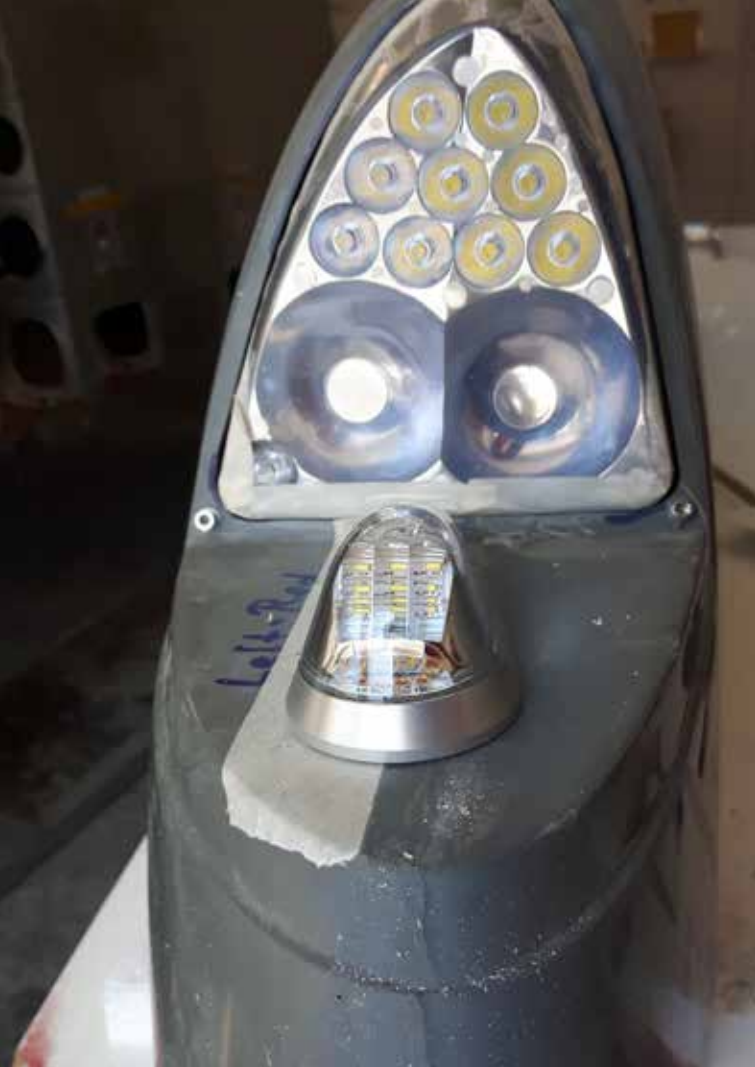
11.06.2019: Der Einbau der Spornradschwinge ist erledigt und am 04.07.2019 wird die extrem helle Beleuchtung von AERO-LED eingebaut. Nachdem das beheizte Pitot-Rohr, die Beleuchtung und der Autopilot-Servo eingebaut sind, können die Flügel zugentstet werden.
