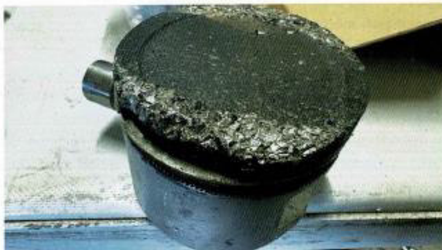
Ein Beispiel für einen aufgrund mangelhaften Kraftstoffs durch klopfende Verbrennung zerstörten Kolben.
