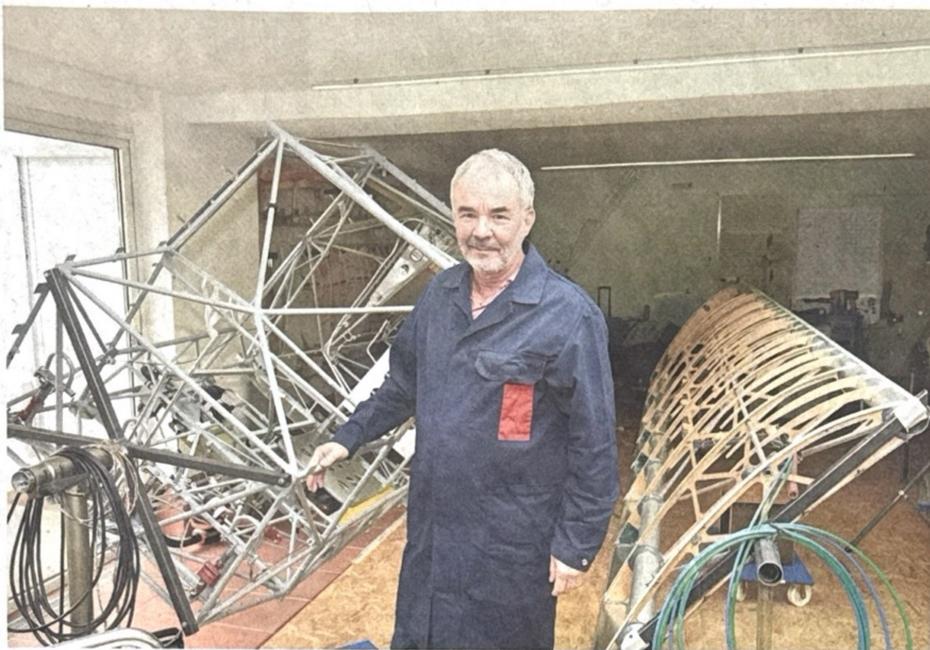
Beat Leu zwischen dem Stahlrohrgerüst des Rumpfs und einer Tragfläche des Flugzeugs, das über dem ehemaligen Swimmingpool im Eigenbau entsteht. FOTO DANIEL ZUMBÜHL
