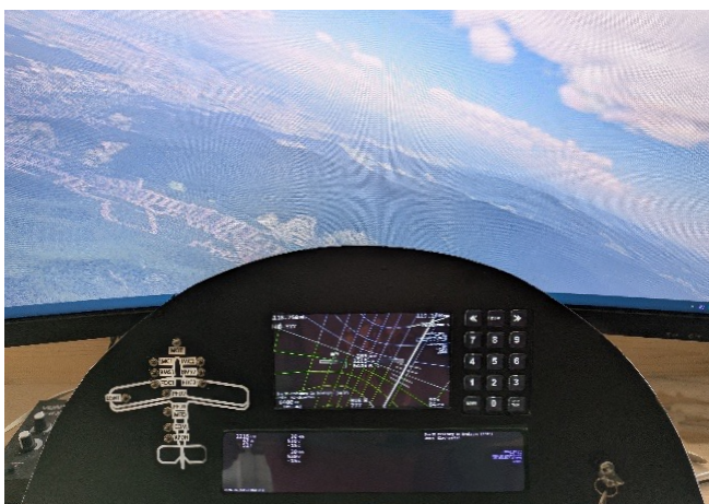
Cockpit-Mock-up. Circuit-Breaker-Panel links. PFD oben, MFD unten. Flugdarstellung simuliert mit X-Plane
