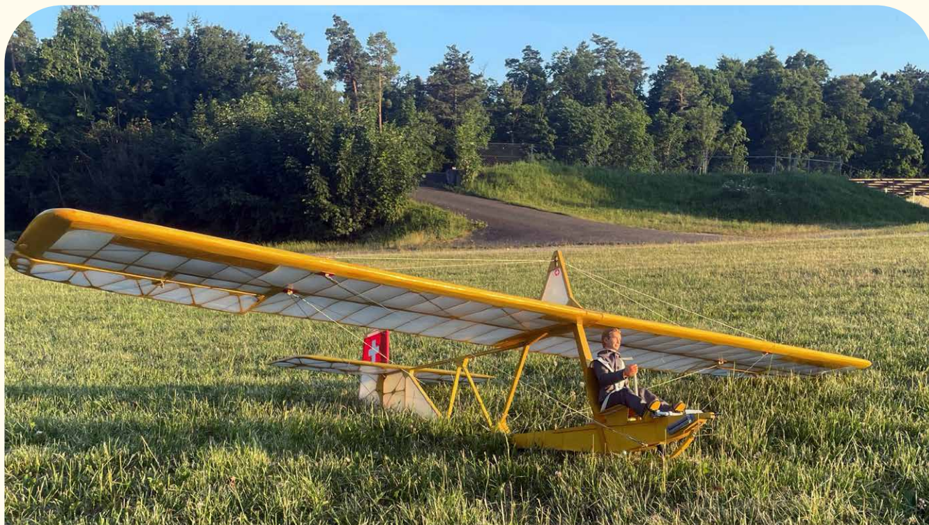
Modell des «Zöglings» im Massstab 1:3 als Vorbereitung für die «grosse» Ausführung.
