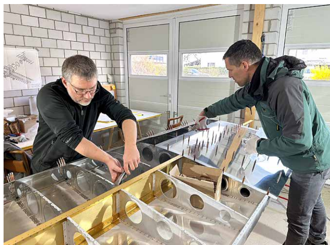
Hand in Hand wird der Flügel gebaut L'aile est construite main dans la main
