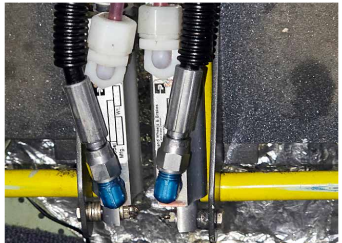
Das Bremssystem mit den betreffenden Zylindern und Explosionszeichnungen der HB-YKD
