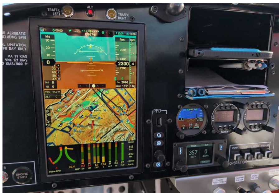
Im EFIS werden alle Flüge aufgezeichnet. Diese Daten dienen als Grundlage für das Flight Log Tous les vols sont enregistrés dans l'EFIS. Ces données servent de base au journal de vol
