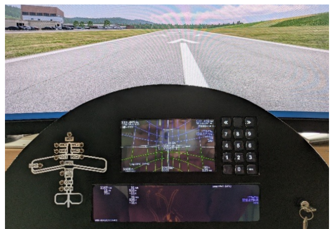
Cockpit-Mock-up. Circuit-Breaker-Panel links. PFD oben, MFD unten. Flugdarstellung simuliert mit X-Plane
