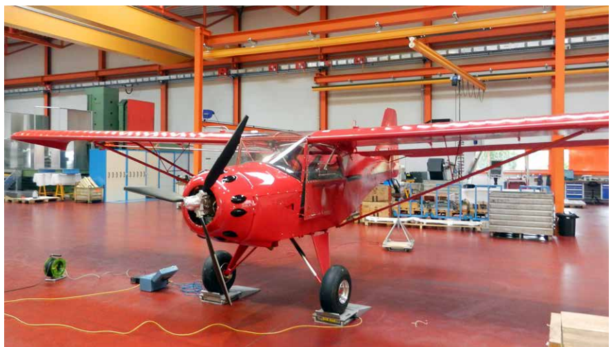
Wägung einer Kitfox kurz vor der Schlussabnahme Pesée d'un Kitfox peu avant la réception finale
