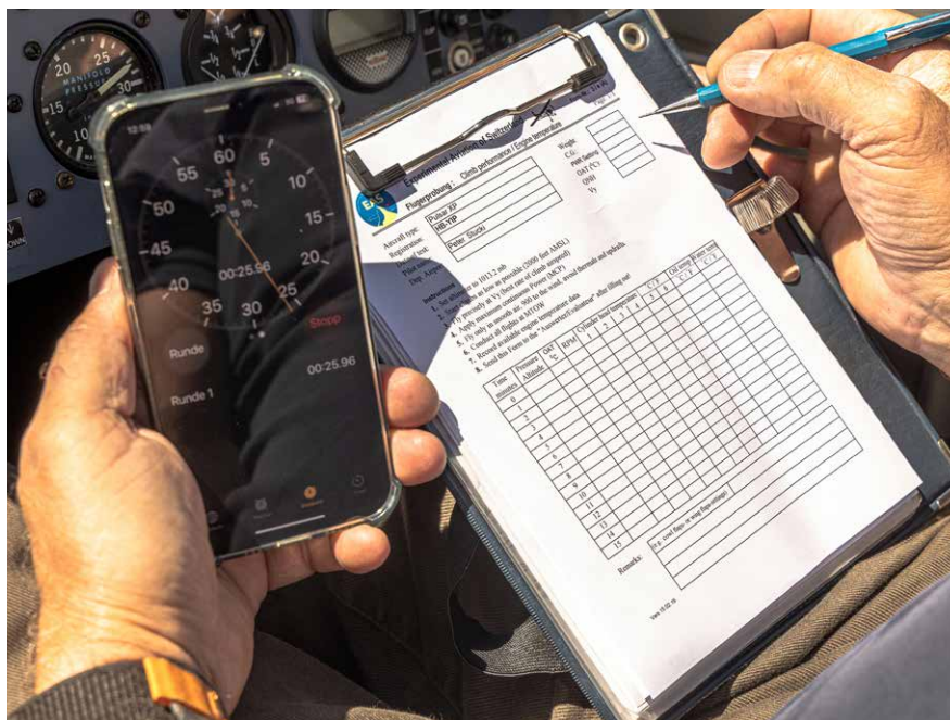
Ermitteln der Steigflugleistung im Cockpit der Pulsar XP HB-YIP von Peter Stucki
