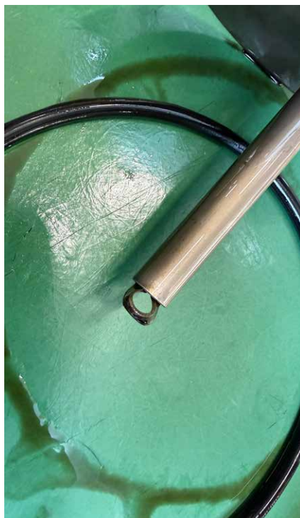
Un objet inconnu dépasse du tuyau d'aspiration du réservoir d'huile
